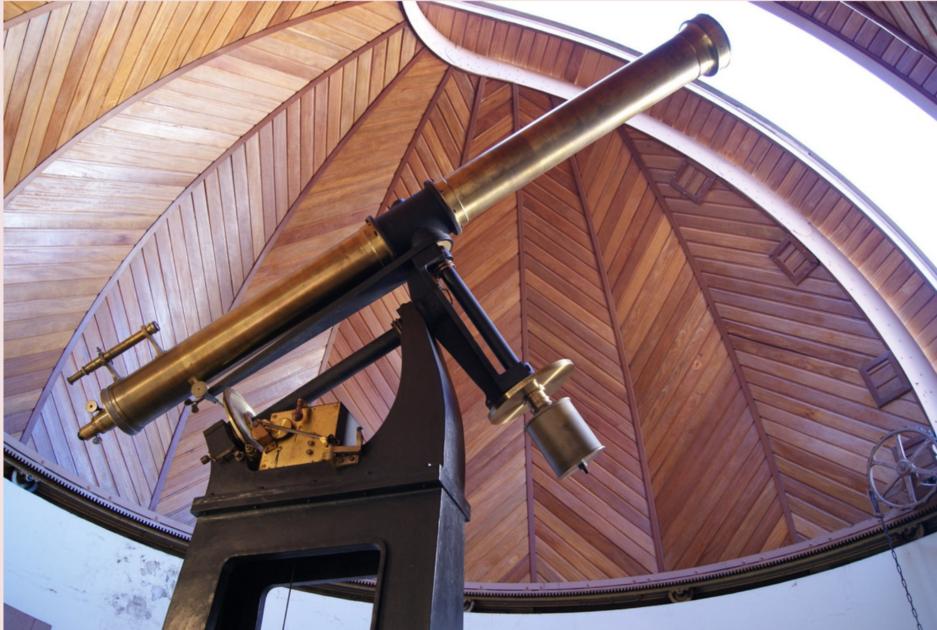
Refrator situado no campus central, montagem equatorial
